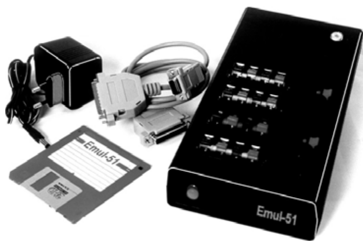
Рис. 2 – Фрагмент печатной платы прибора (а) и отладочное устройство (б) в комплекте с блоком питания и соединительным нуль-модемным кабелем.
